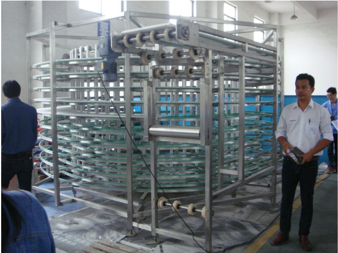
ตัวอย่าง โครงสร้างของ Spiral Conveyor Modular Belt Type
