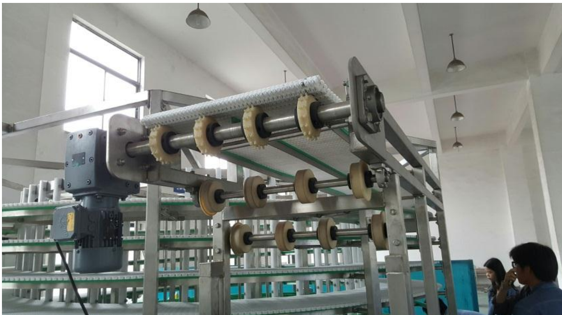
ตัวอย่างการติดตั้ง ชุดขับของ Spiral Conveyor Modular Belt Type
